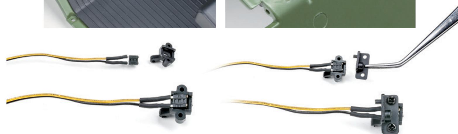
**Шаг 3.** Поместите выключатель стоп-сигнала внутрь кронштейна выключателя. При этом провода выключателя должны выходить со стороны крепежного кронштейна для штока педали тормоза. Поверх выключателя установите кронштейн педали тормоза. Совместите крепежные отверстия двух кронштейнов и закрепите детали двумя винтами 1,7×4 (АР).
