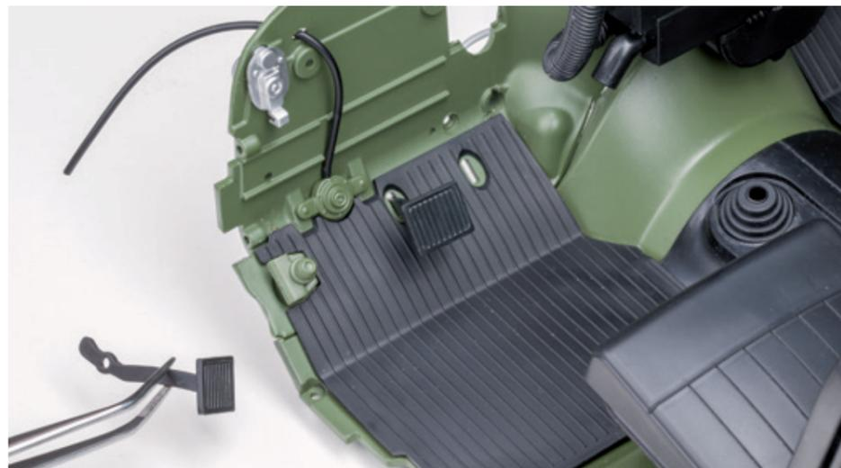
**Шаг 4.** В правом отверстии наклонной части пола салона установите педаль тормоза. Закрепите собранный ранее выключатель стоп-сигнала в отверстии штока педали тормоза. Для фиксации используйте винт 1,7×4 (AP).
