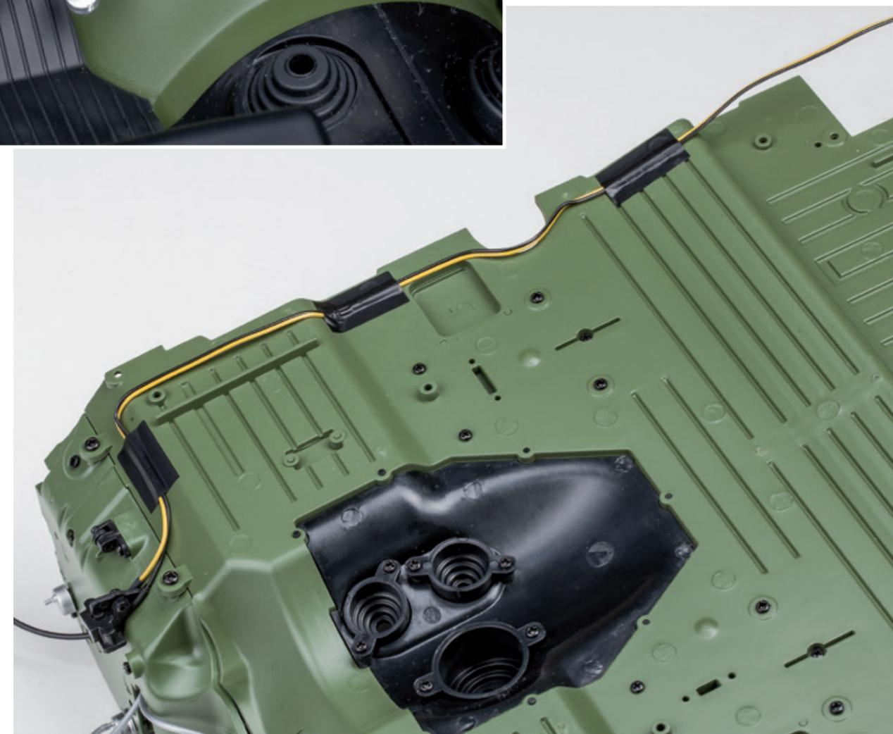
**Шаг 7.** При помощи отрезков клейкой ленты зафиксируйте провод выключателя стоп-сигнала вдоль левого края пола салона. Провод должен сначала отойти от выключателя вниз (по наклонной части перегородки моторного отсека), а затем уйти в сторону левого порога модели. Обратите внимание: провод должен обойти вырез под заливную горловину левого бензобака.
