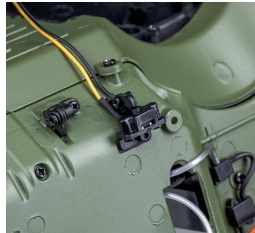
**Шаг 5.** Разместите кронштейн педали тормоза на перегородке моторного отсека и закрепите его с внутренней стороны салона винтом 1,7×4 (AP). По окончании монтажа проверьте подвижность педали тормоза. При нажатии на площадку педали выключатель стоп-сигнала должен срабатывать (щелкать).
